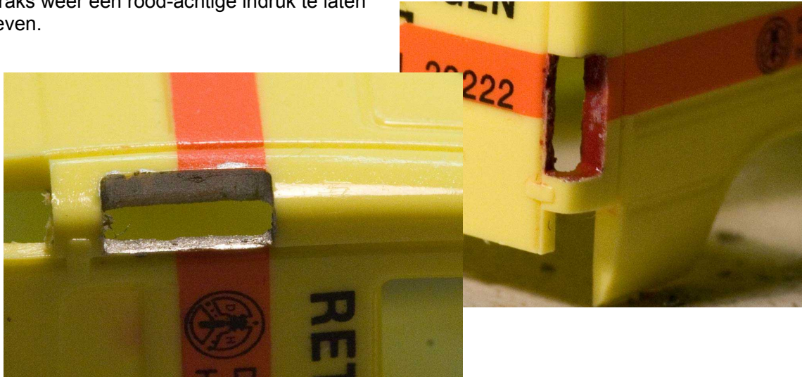
Foto 3 en 4: De binnenzijde van de achterlichten wordt afgedekt met verf om doorschijnen in de kap te voorkomen en het achterlicht weer een roodachtig uiterlijk te geven.
