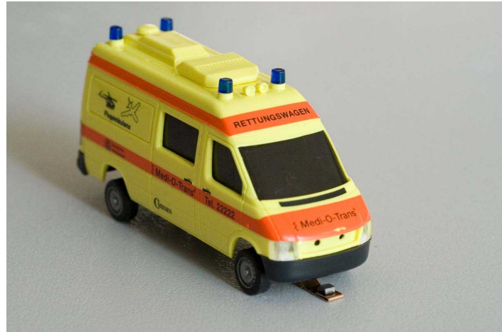
Foto 1: Het origineel. De grille is er naar voren uitgewipt, daarmee zit de kap op het onderstel vast
