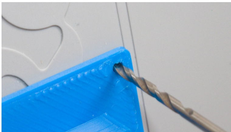
Abbildung 11: Bohren von Löchern für das Sensormodul
