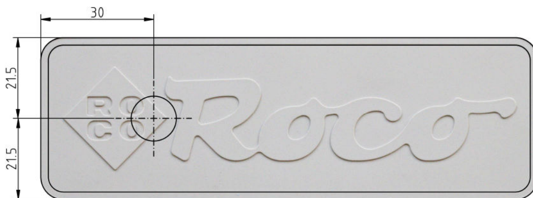
Abbildung 8: Position für die Öffnung für den Magnethalter
