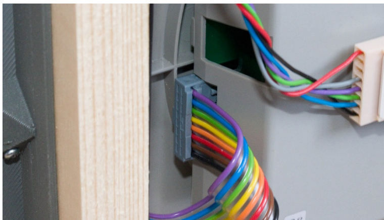
Abbildung 15: Anschluss des Bandkabels an die Drehscheibe
