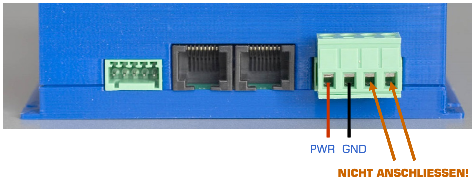
Abb. 12: Anschluss der Stromversorgung an den TM44
