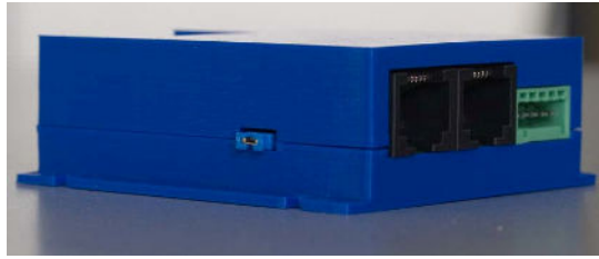
Abb. 12: Clockbus Terminator Jumper an der Seite des RM-C/2-Gehäuses
