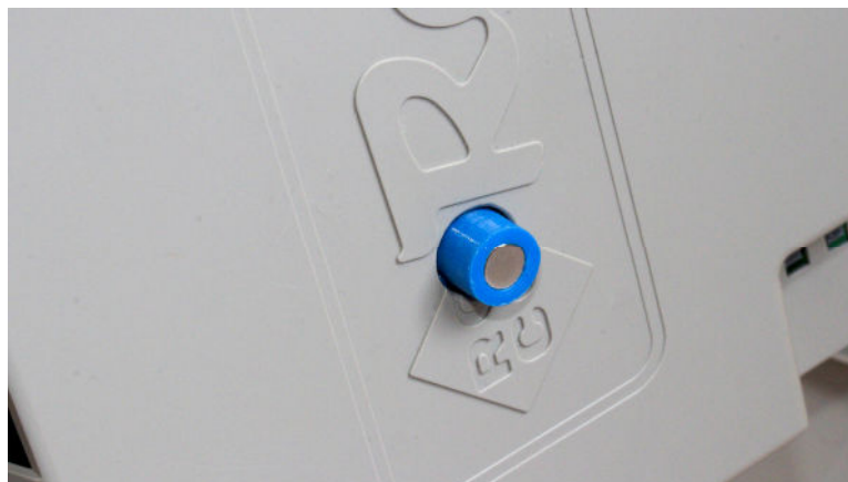
Figuur 10: Kap met geplaatste magneet
