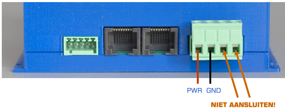
Fig 13: Aansluiten voeding op TM44
