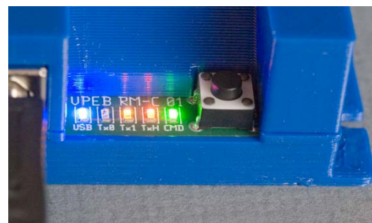
Fig. 4 : RM-C Leeds et bouton réinitialisation
