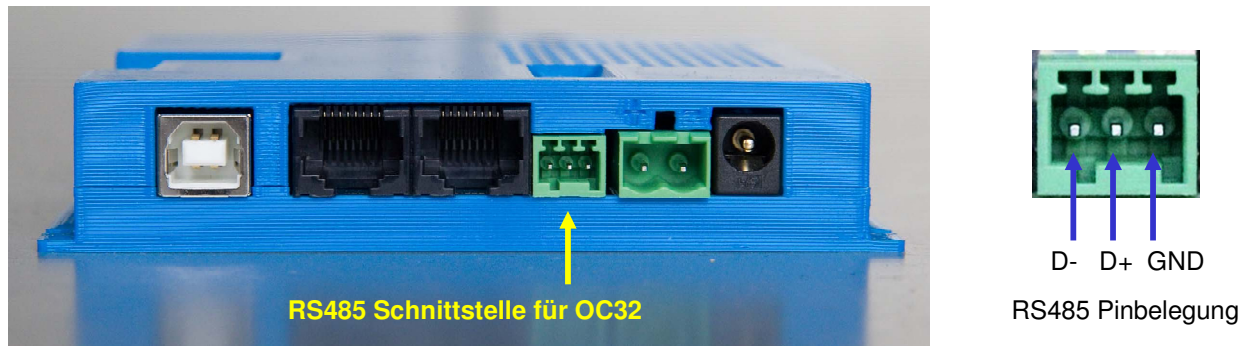
Abbildung 8: RS485-Anschluss für OC32 (altes Modell)
