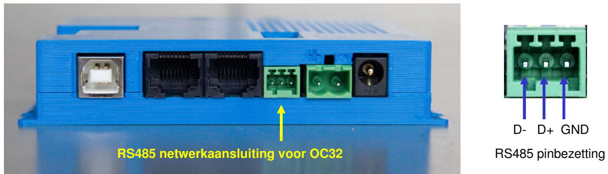
Figuur 8: RS485 aansluiting voor OC32 (oud model)
